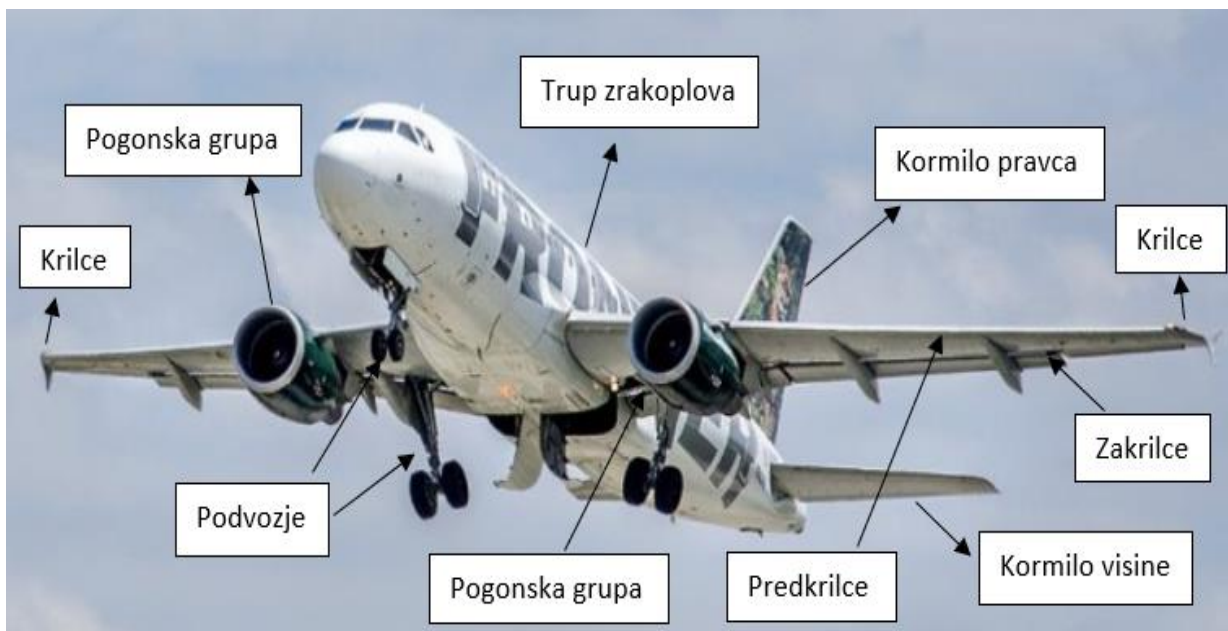
Slika 9. Izvori buke na zrakoplovu, [17]
