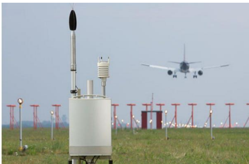
Slika 5. Stanica za mjerenje buke, [12]
