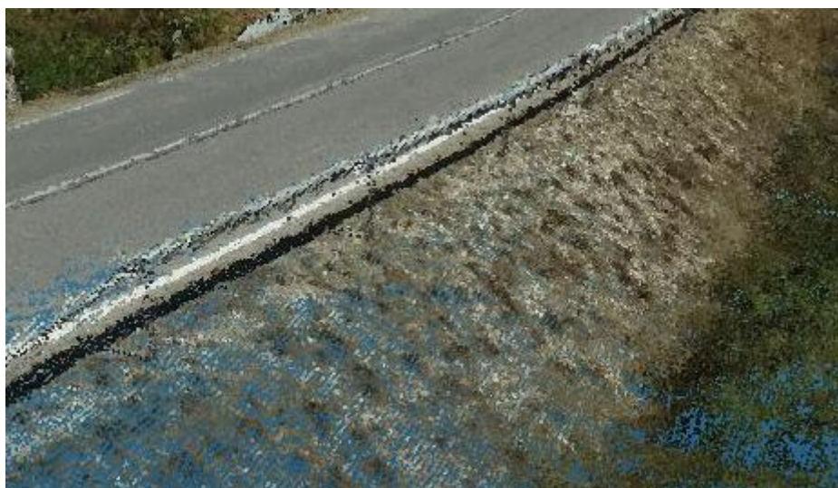
Slika 60 Oblak točaka snimljene ceste (uvećano)
