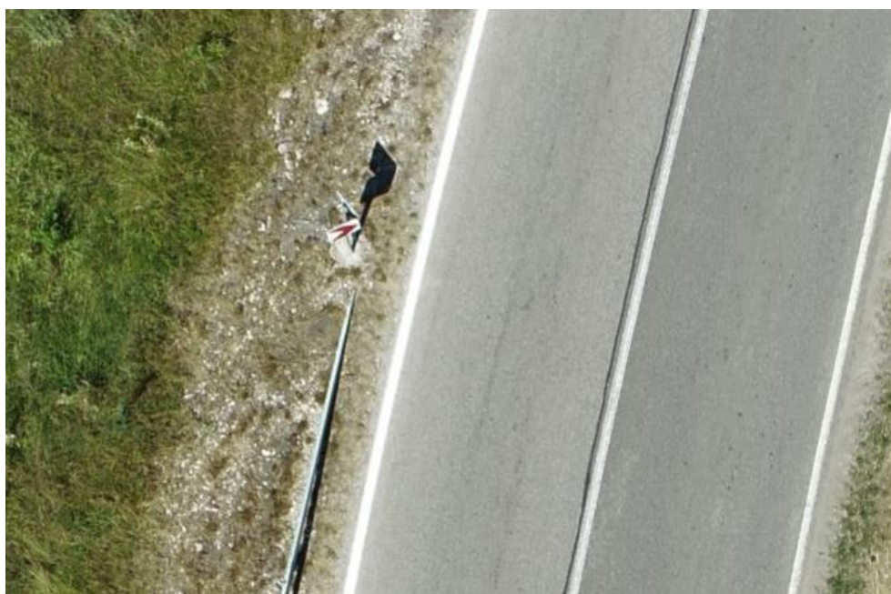
Slika 45 Fotografija znaka za zavoj na cesti snimljena iz zraka s nagibom kamere od -90^\circ
