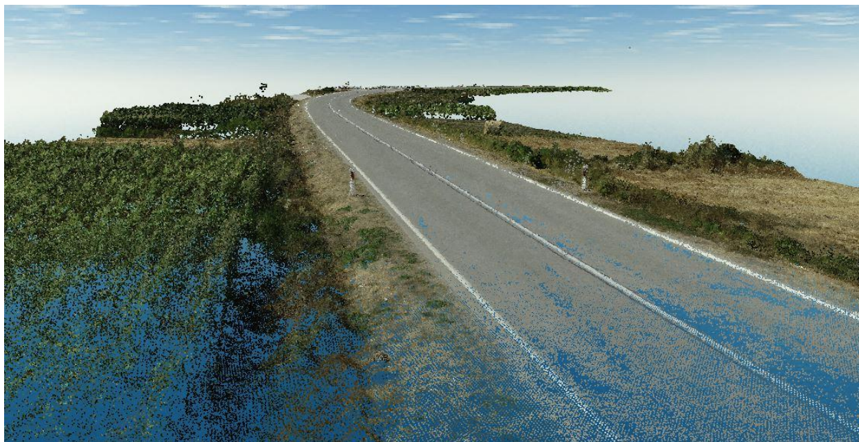
Slika 59 Oblak točaka snimljene ceste
