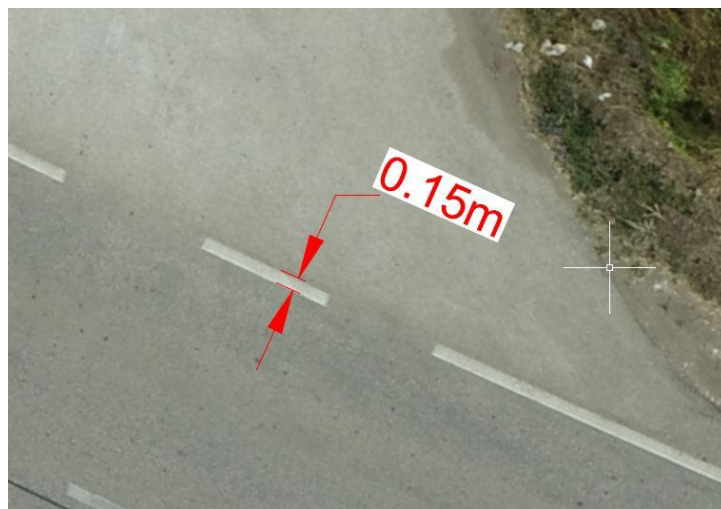
Slika 58 Dimenzija oznake na kolniku na snimljenoj cesti
