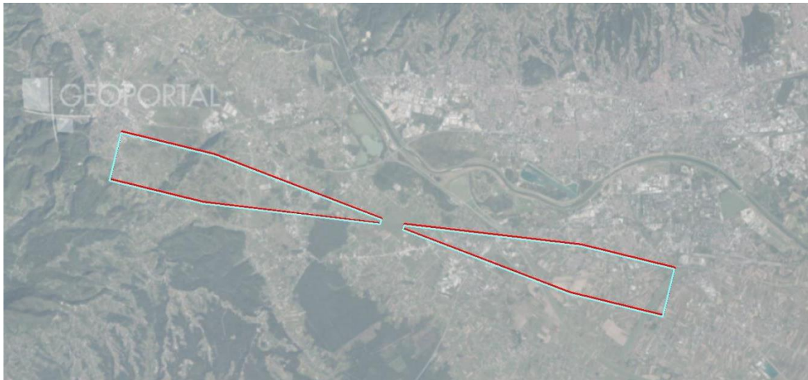
Slika 23. Granica područja putanje polijetanja sjeverne i južne USS-e Aerodromske karte prepreka ICAO tip A
