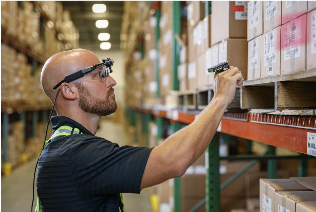
Slika 10. Skeniranje robe u skladištu primjenom skenera montiranog na naočale
