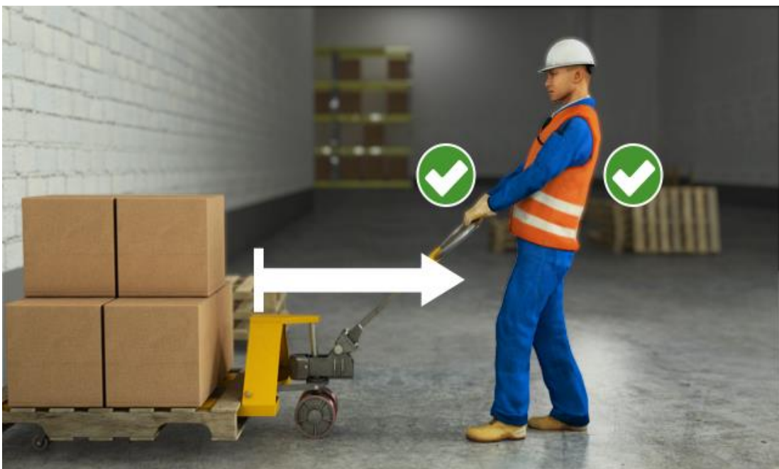
Slika 7. Prikaz pravilnog korištenja paletnog viličara
