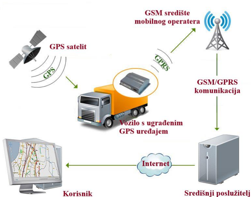
Slika 2. Funkcioniranje sustava za upravljanje voznim parkom
