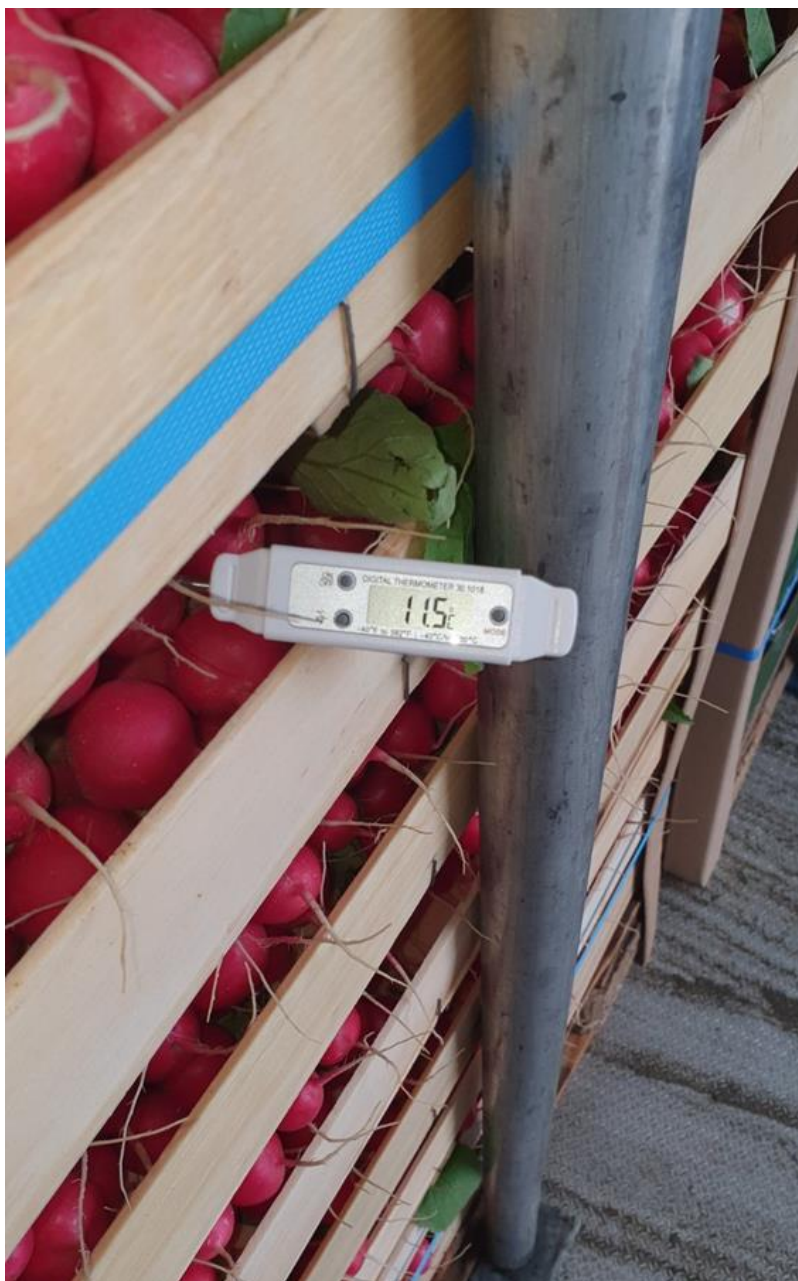
Slika 25. Mjerenje temperature robe ubodnim termometrom
