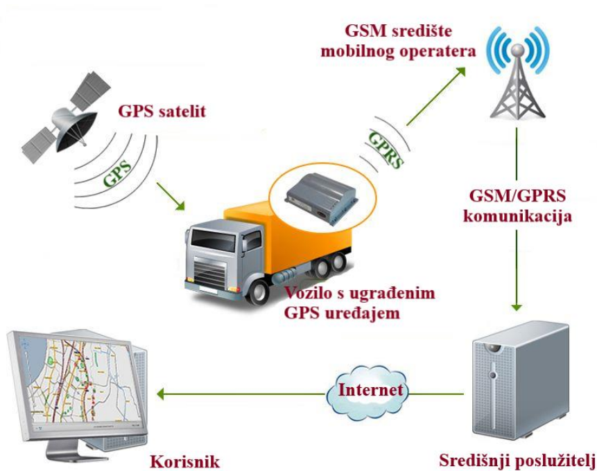
Slika 2. Funkcioniranje sustava za upravljanje voznim parkom
