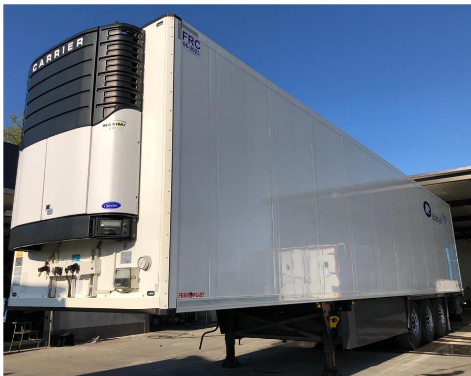
Slika 21. Poluprikolica sa mehaničkim rashladnim uređajem Carrier
