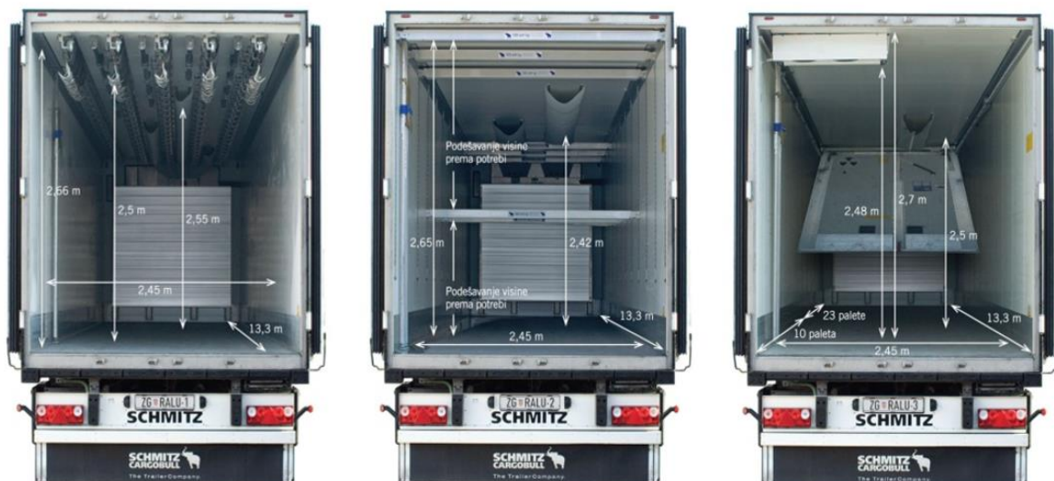
Slika 15. Primjeri hladnjača : s visećim kukama, s dvostrukim podom, dvorežimska
