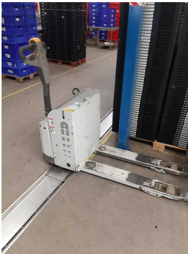
Slika 15. Ručni viličar kakav se koristi u skladištu dm-a
