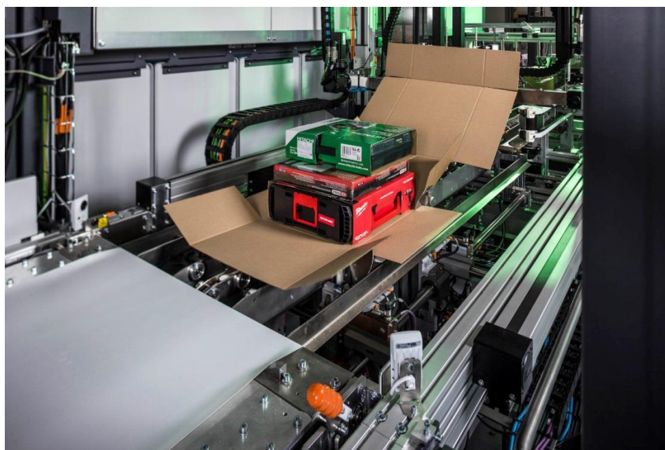
Slika 10. Stroj za automatsko pakiranje proizvoda
