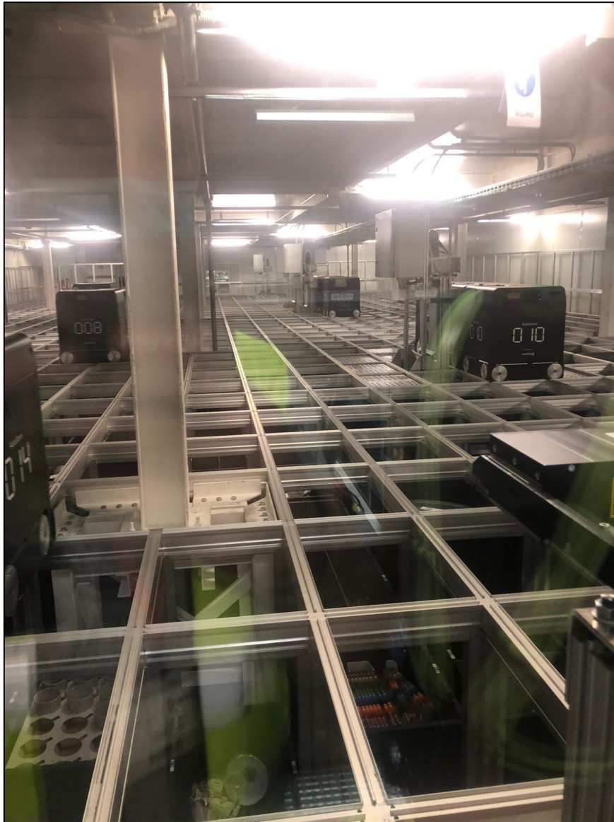
Slika 29. Prikupljanje artikala robotom Izvor: autor
