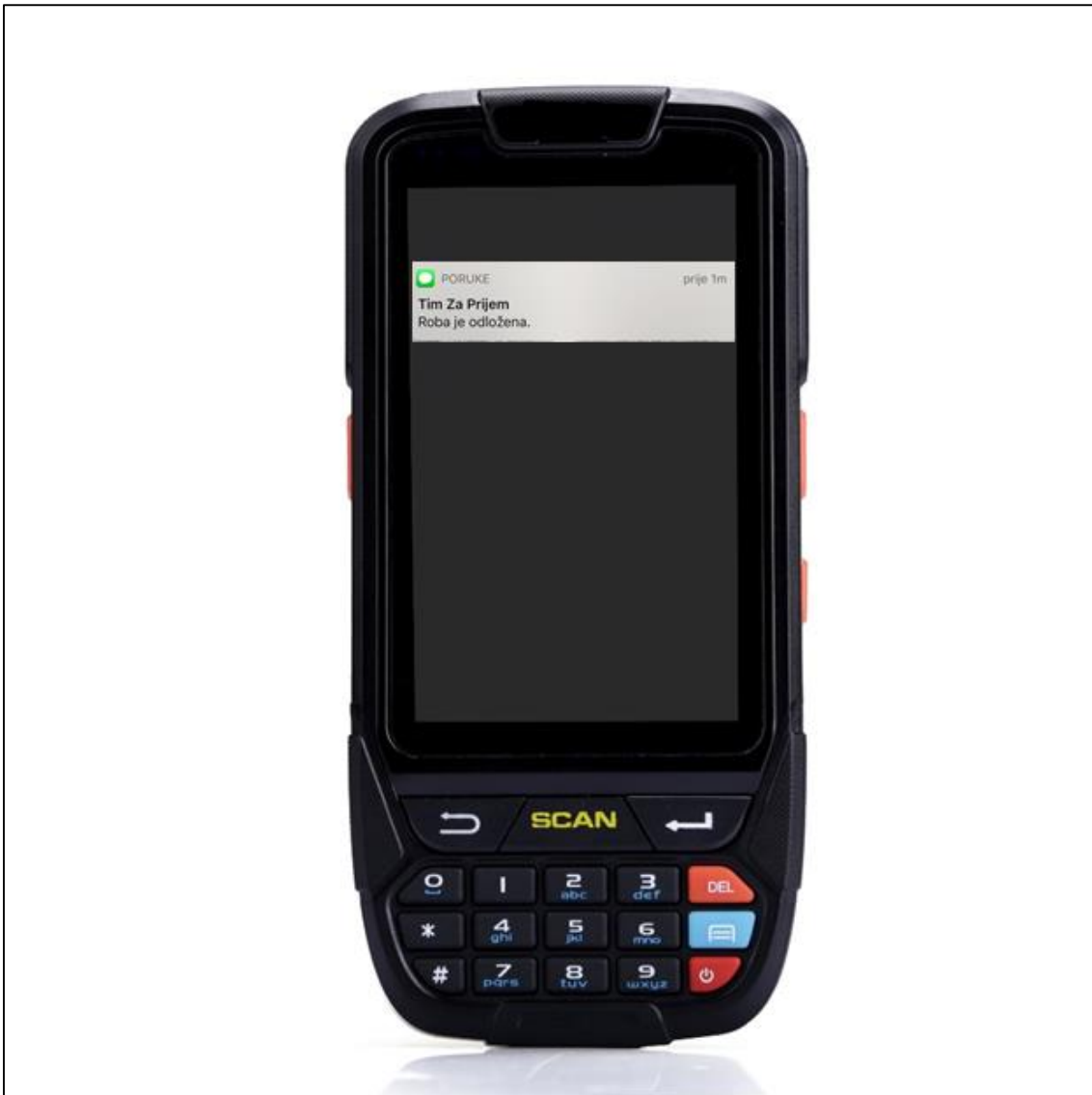
Slika 31. Barkod skener s obavijesti Izvor:autor
