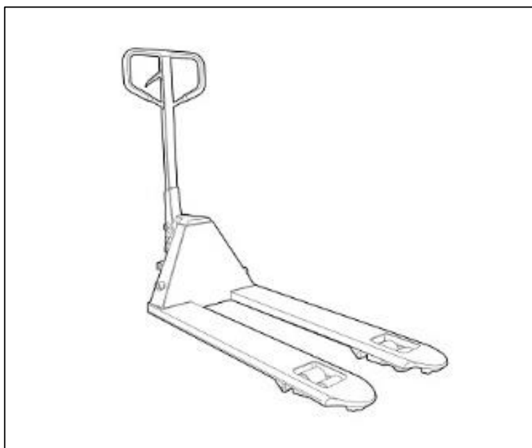
Slika 9. Ručni viličar Izvor: [27]
