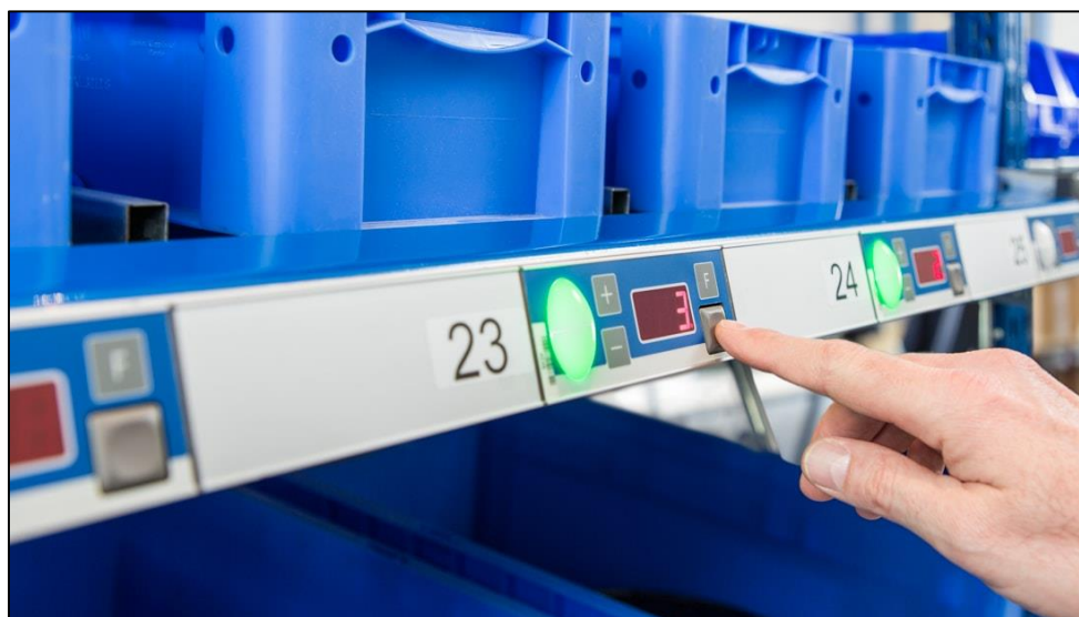
Slika 5. Komisioniranje pomoću svjetla Izvor: [18]
