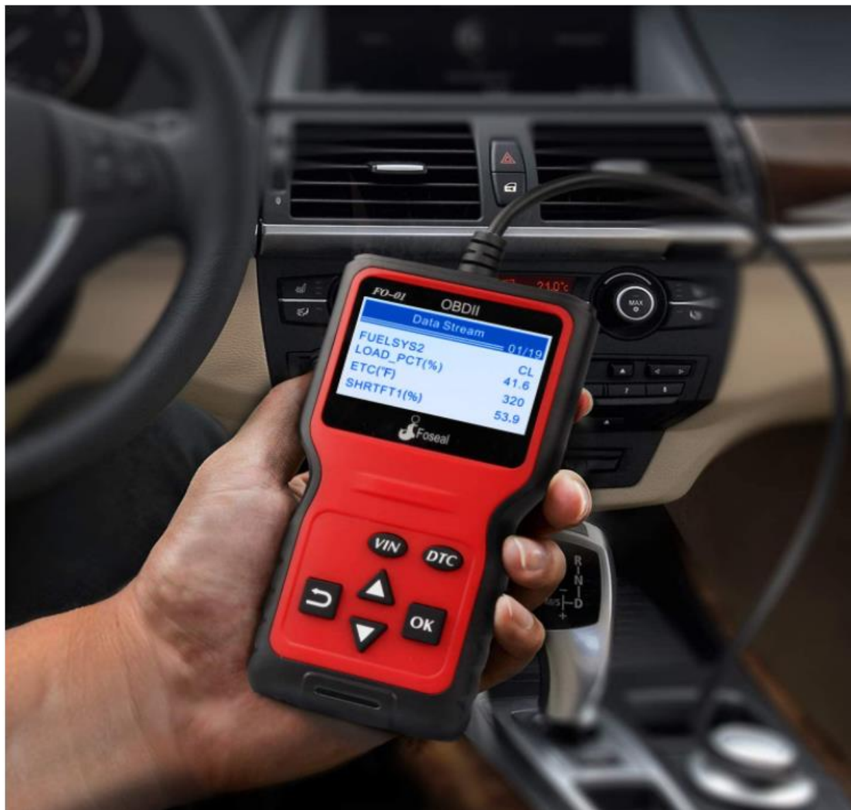
Slika 1. Prikazuje OBD skener u radu 11
