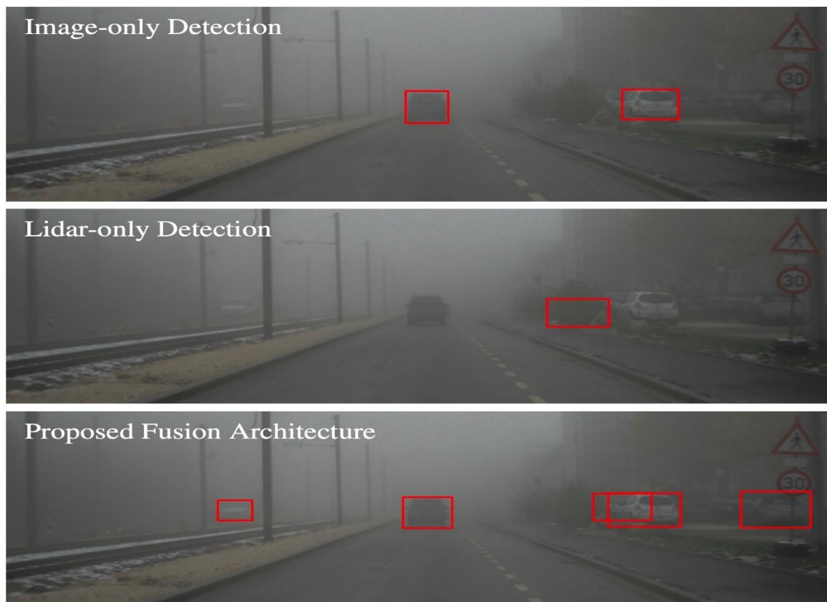
Slika 7. Detekcija objekata u otežanim uvjetima: samo pomoću kamere, samo pomoću Lidara, pomoću oba senzora 23
