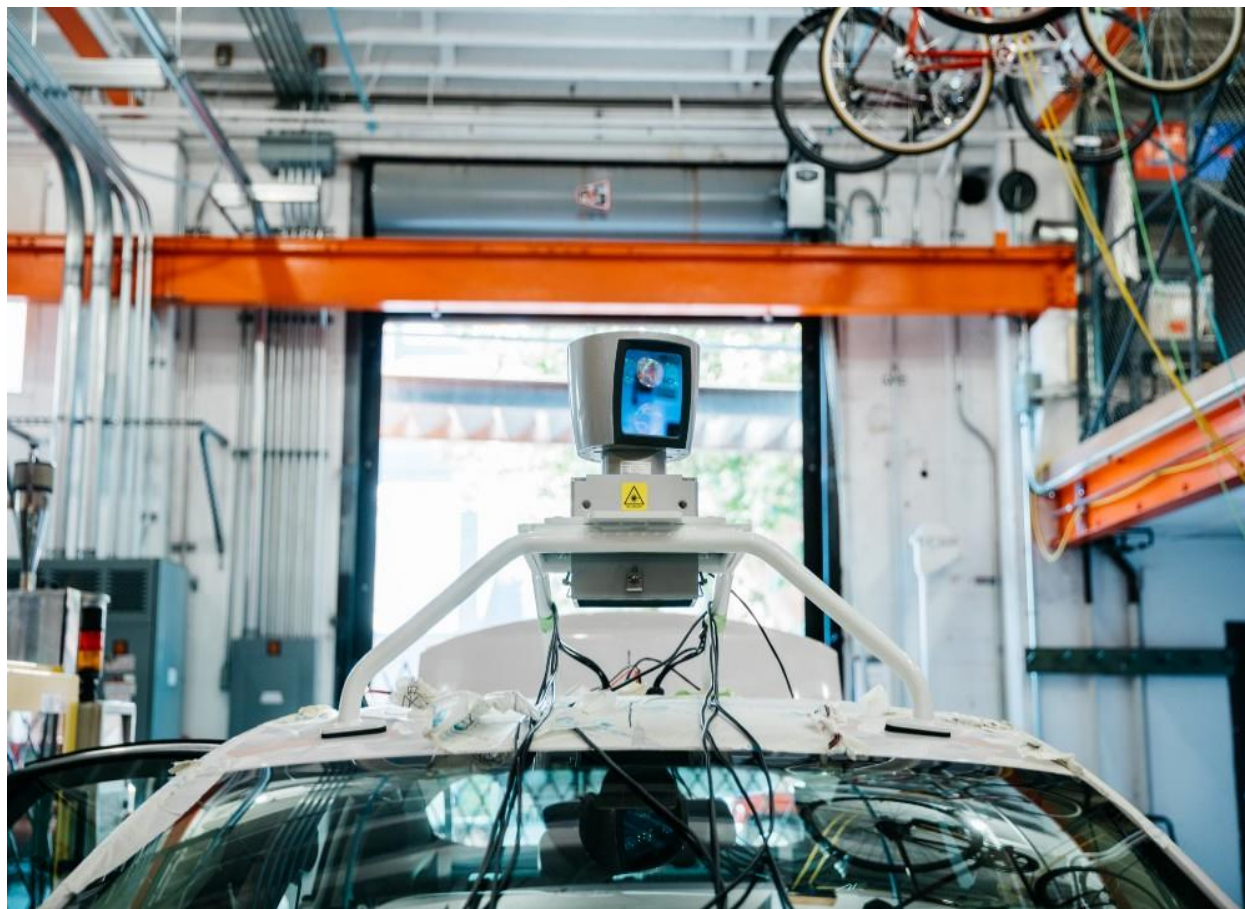
Slika 8. Prikaz LIDAR senzora pričvršćenog na krov autonomnog vozila 24
