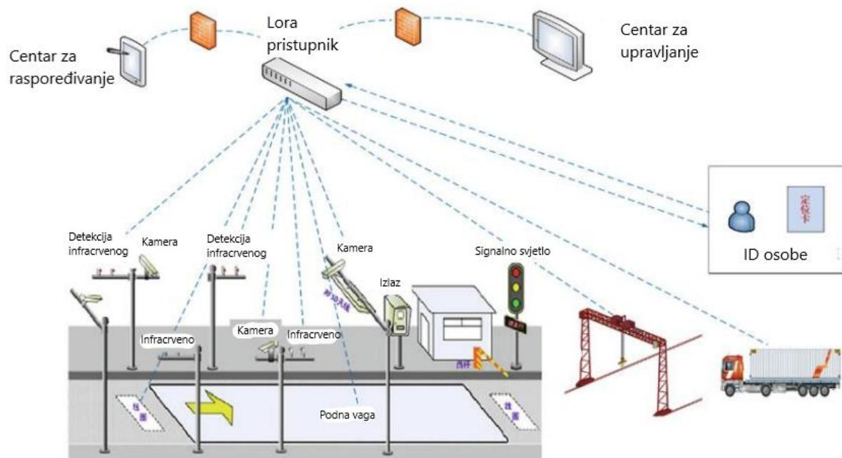
Slika 9. IoT dvorište temeljeno na Lora tehnologiji [22]
