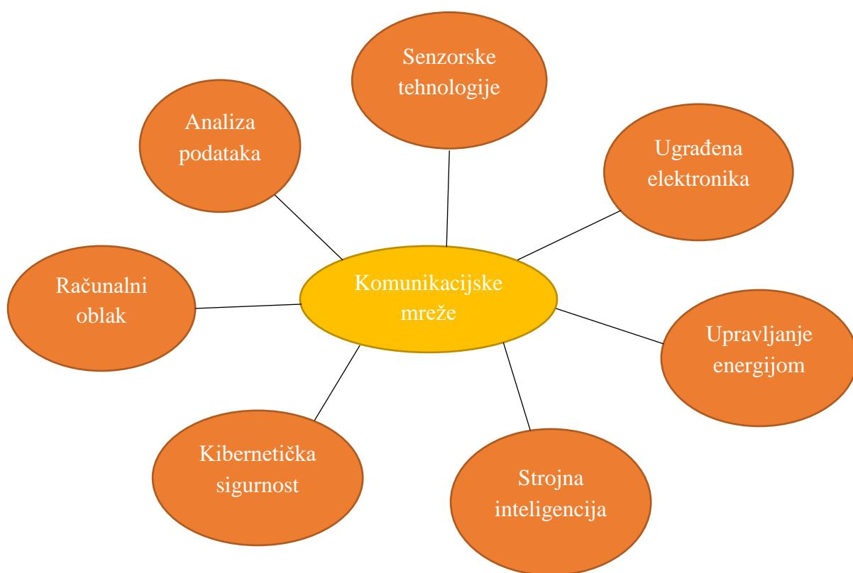
Slika 3. Opći blok dijagram IoT sustava [5]
