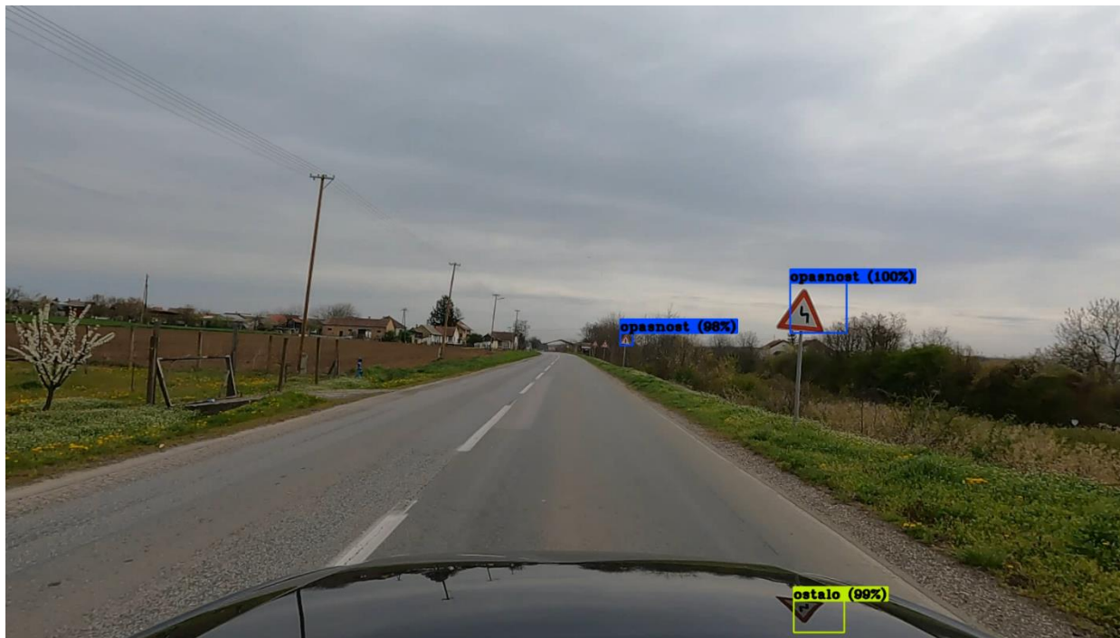
Slika 20: Rezultati detekcije prometnih znakova YOLO algoritmom
