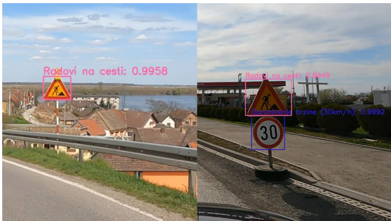
Slika 30: Prepoznavanje prometnog znaka radovi na cesti
