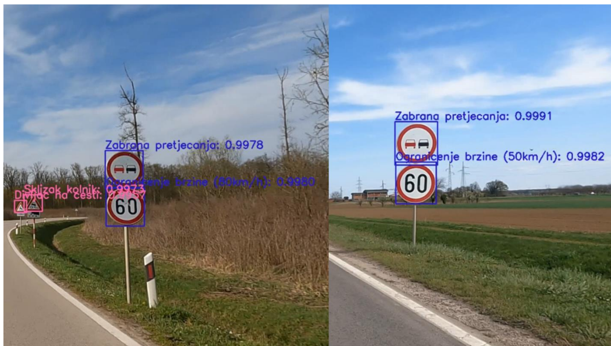
Slika 28: Prikaz problema u prepoznavanju ograničenja brzine 60
