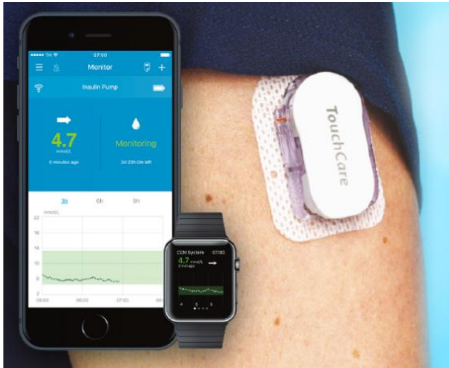
Slika 2. TouchCare Slim CGM sustav za kontinuirano mjerenje glukoze u realnom vremenu
