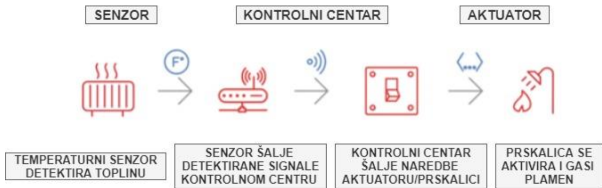
Slika 3. Rad senzora i aktuatora
