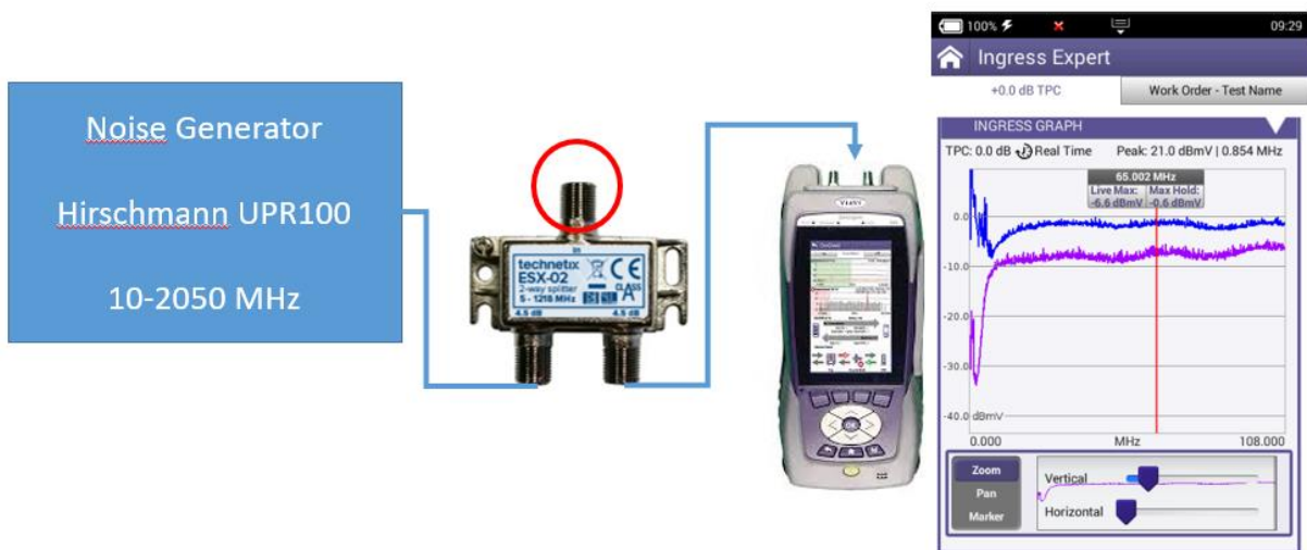
Slika 33. Imitacija greške u instalacijama
