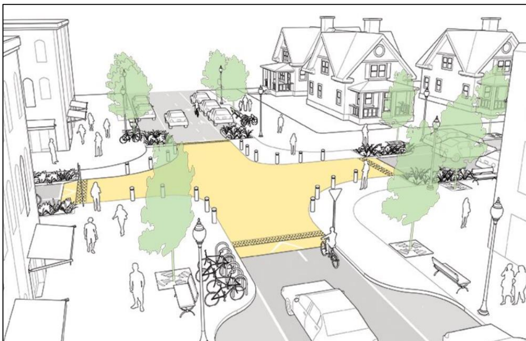
Slika 8 Ilustracija izdignutog raskrižja. Izvor: [9]
