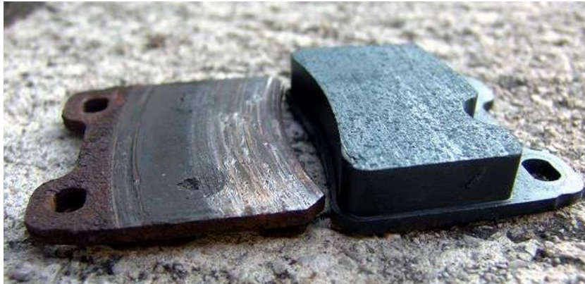
Slika 16. Potrošena i nova kočiona obloga
