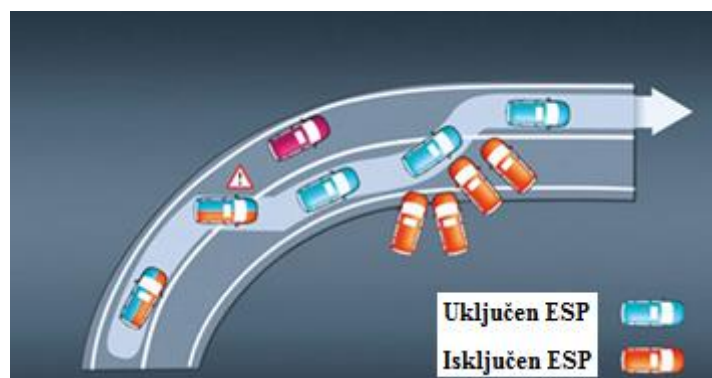
Slika 20. Ponašanje vozila s uključenim i isključenim ESP-om
