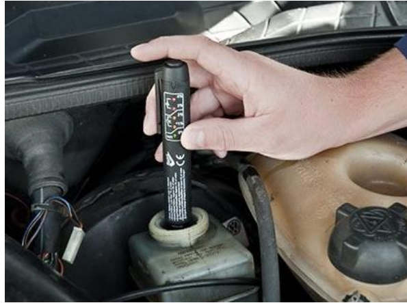
Slika 22. Ispitivanje kvalitete kočione tekućine
