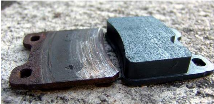
Slika 16. Potrošena i nova kočiona obloga
