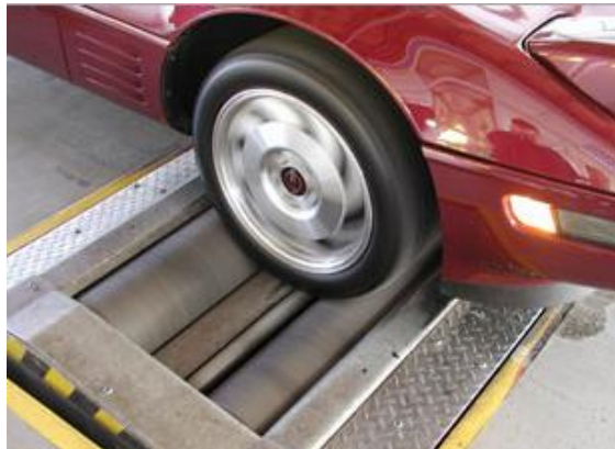
Slika 21. Ispitivanje kočnica na valjcima
