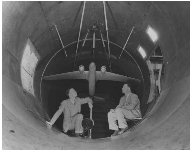
Slika 15. Prikaz testiranja zrakoplova u zračnom tunelu
