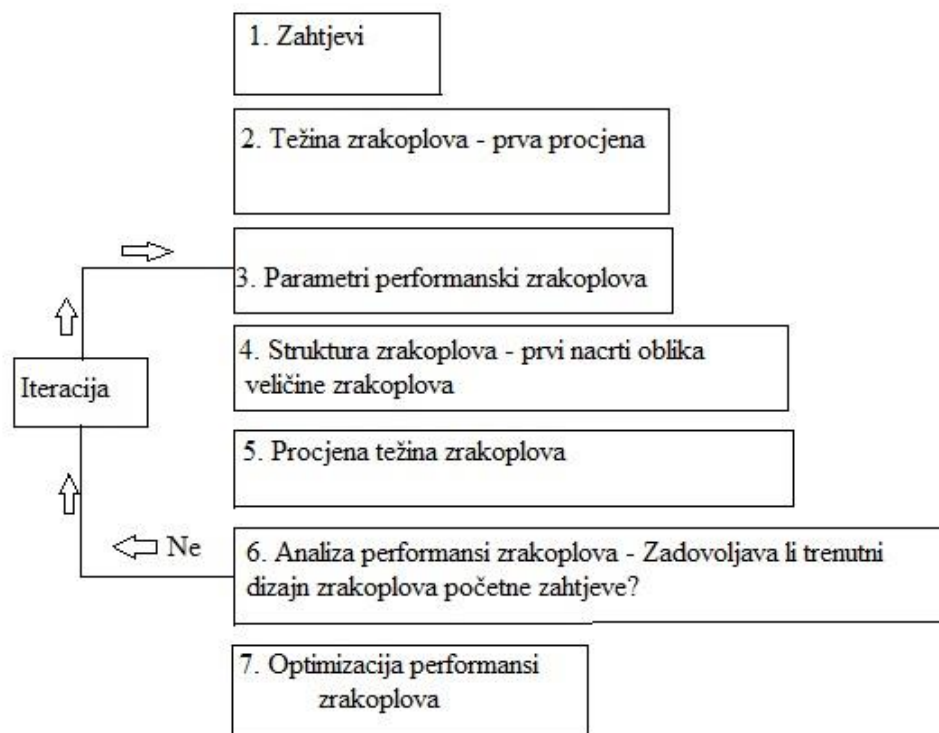
Slika 5. Shema procesa konceptnog konstruiranja zrakoplova
