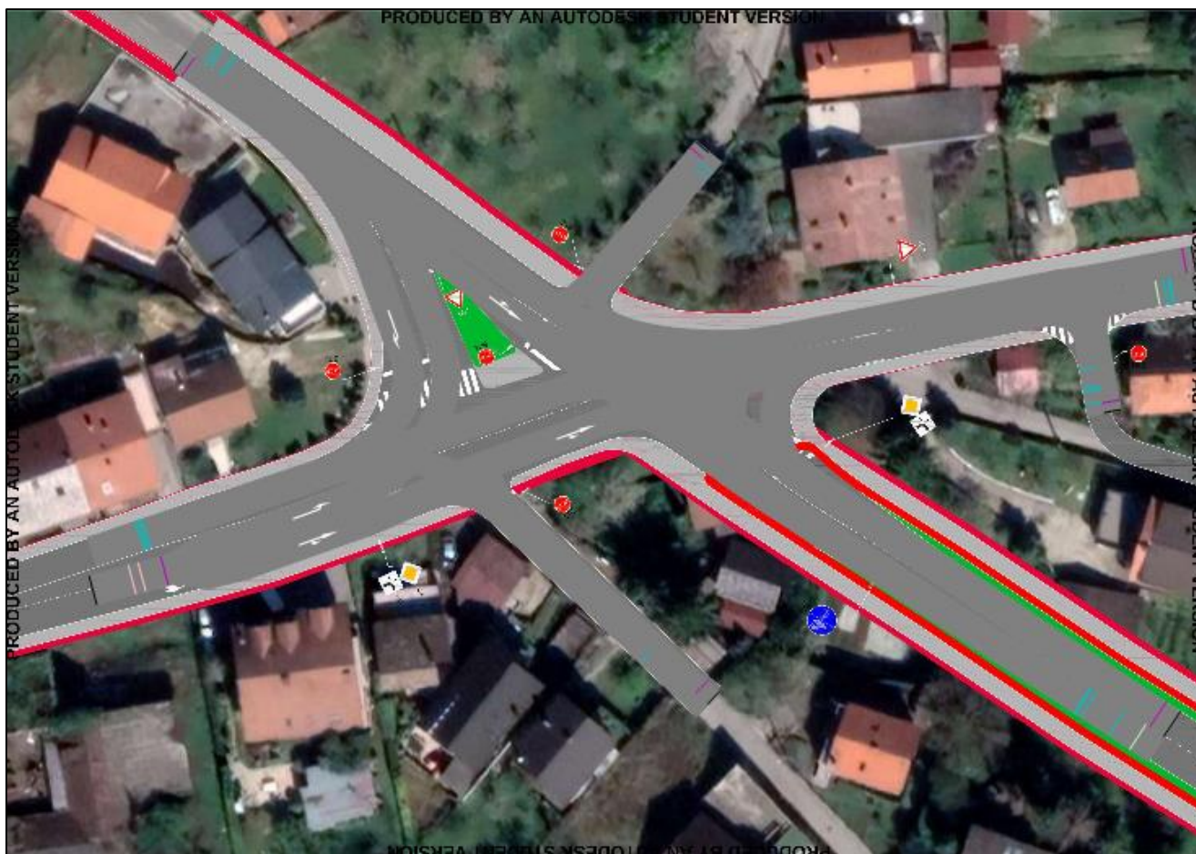
Slika 26. Prikaz simulacijskom modelu za raskrižje Gračanske i Markuševečke ceste, ulice Bliznec i nove prometnice sukladno GUP-u unutar programskog alata PTV Vissim
