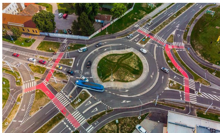
Slika 2.9. Turbo kružno raskrižje
