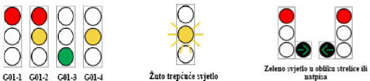
Slika 16. Prikaz oblika i boja prometnih svjetla za upravljanje prometom u RH
