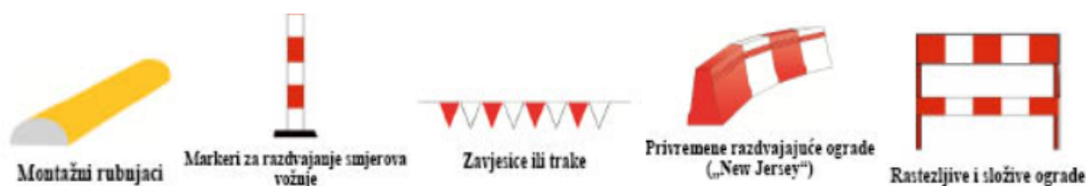
Slika 24. Oprema za vođenje i usmjeravanje prometa u zoni radova na cesti, zapreka, privremenih opasnosti i oštećenja kolnika
