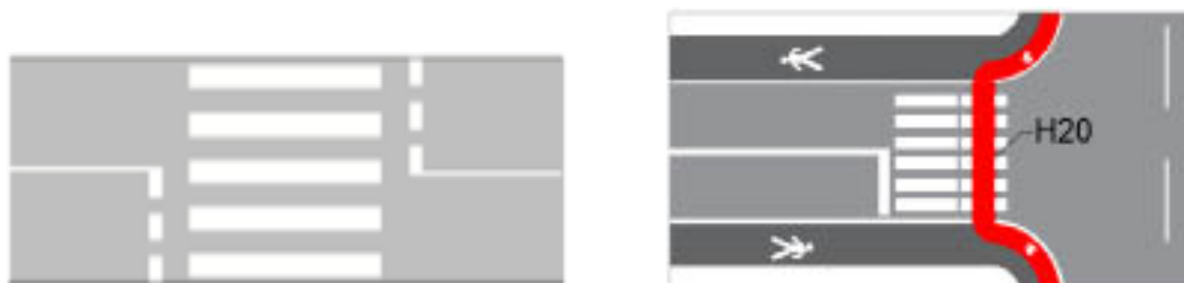
Slika 11. Pješački i biciklističko-pješački prijelaz obilježeni poprečnim oznakama na kolniku
