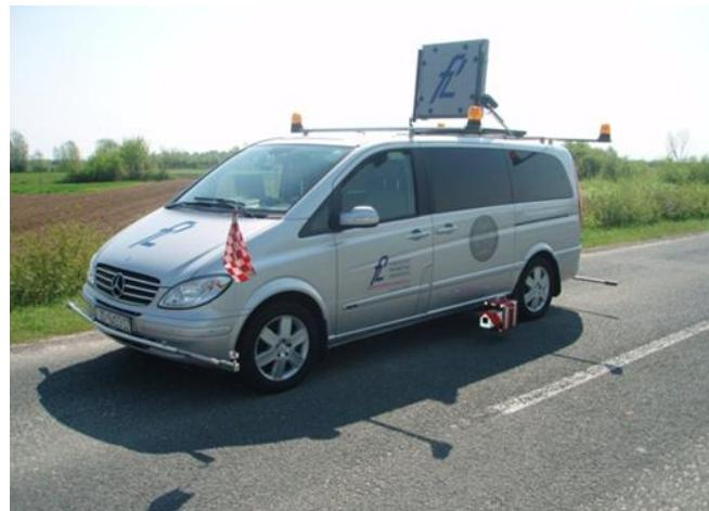
Slika 9. Mjerno vozilo s postavljenim uređajem ZDR 6020.
