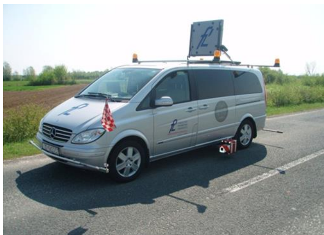
Slika 9. Mjerno vozilo s postavljenim uređajem ZDR 6020.
