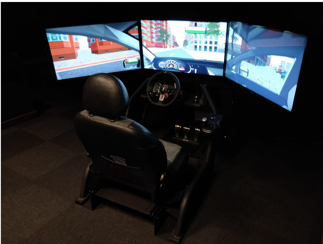
Slika 7. Prikaz simulatora vožnje korištenog za istraživanje
