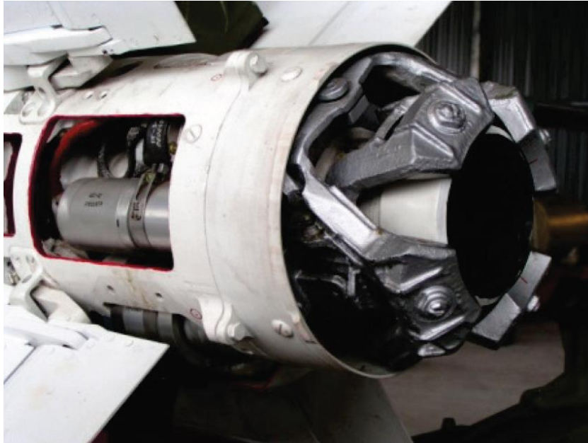
Slika 11. Segmentni kupolasti deflektor (R73 zrak-zrak raketa) [10]
