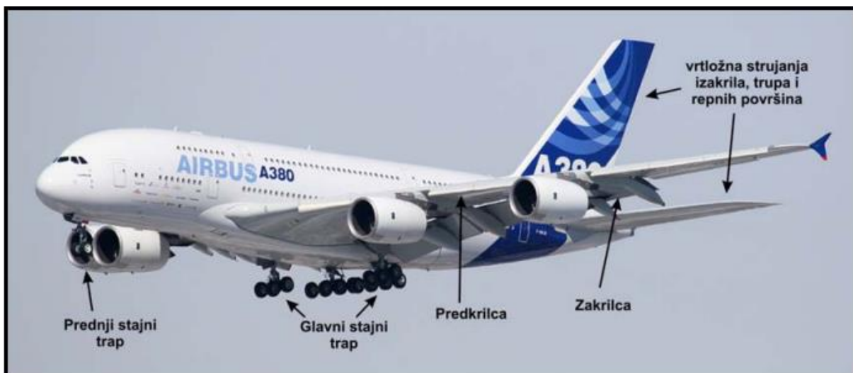
Slika 4. Izvori strukturne buke zrakoplova, IZVOR: [5]
