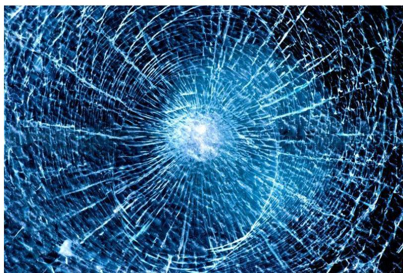
**Slika 2.** Lom kaljenog vjetrobranskog stakla uslijed vanjskog udara
