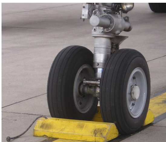
Slika 3.2: Podmetači ispod prednjih kotača
