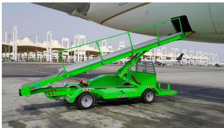
Slika 3.7: Pokretna traka za istovar prtljage
