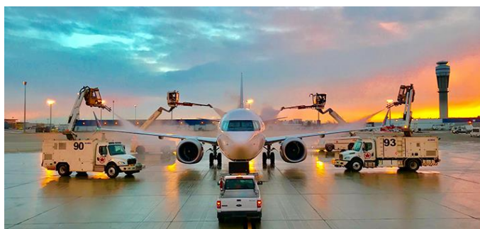
Slika 3.15: Proces odleđivanja zrakoplova
