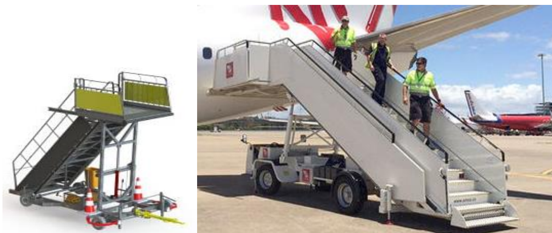
Slika 3.5: Prikaz vučenih i samohodnih stepenica
