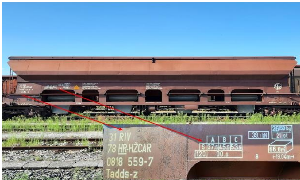
Slika 9 Prikaz Tadds-z vagona i oznaka na vagonu (Izvor: Autor)
