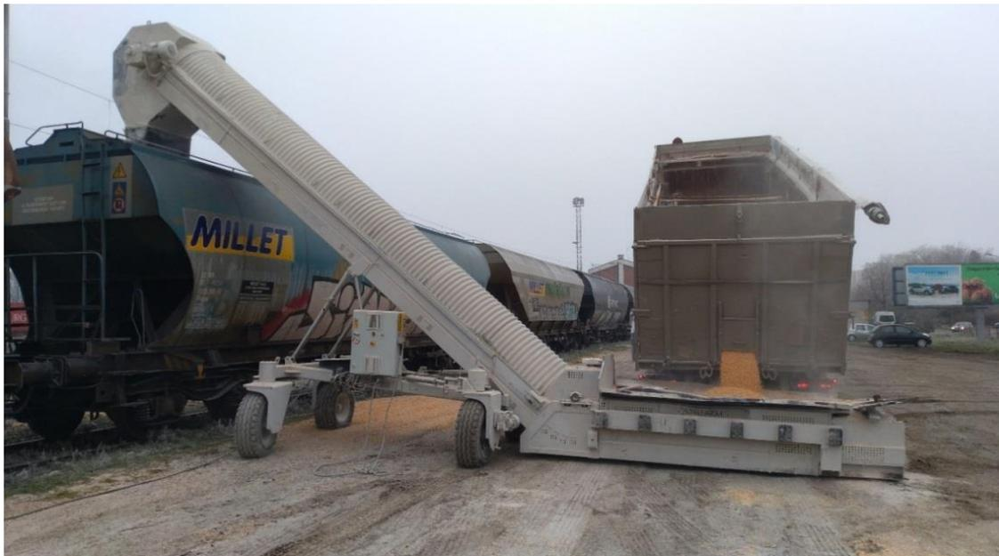
**Slika 8** Utovar vagona kukuruzom pomoću trakastog transportera u kolodvoru Koprivnica
