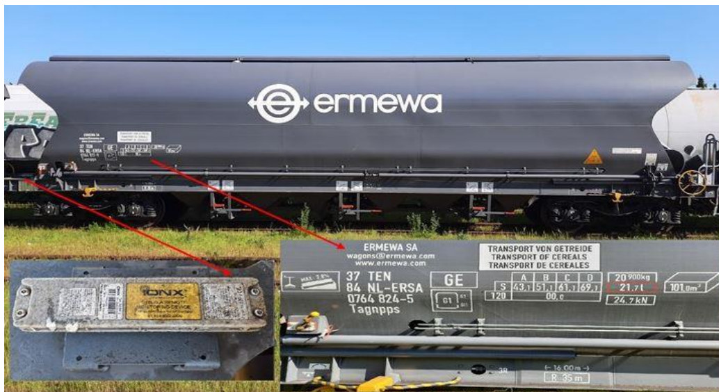
Slika 11 Teretni vagon tvrtke Ermewa s oznakama i GPS uređajem (Izvor: Autor)
