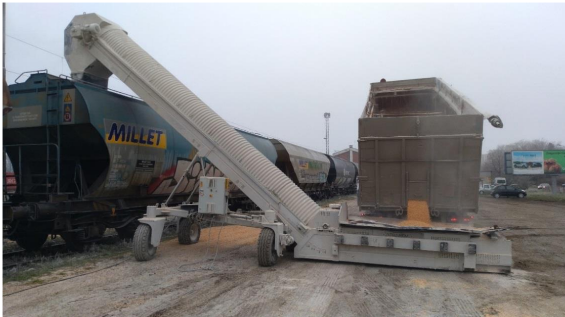
Slika 8 Utovar vagona kukuruzom pomoću trakastog transportera u kolodvoru Koprivnica (Izvor: Autor)
