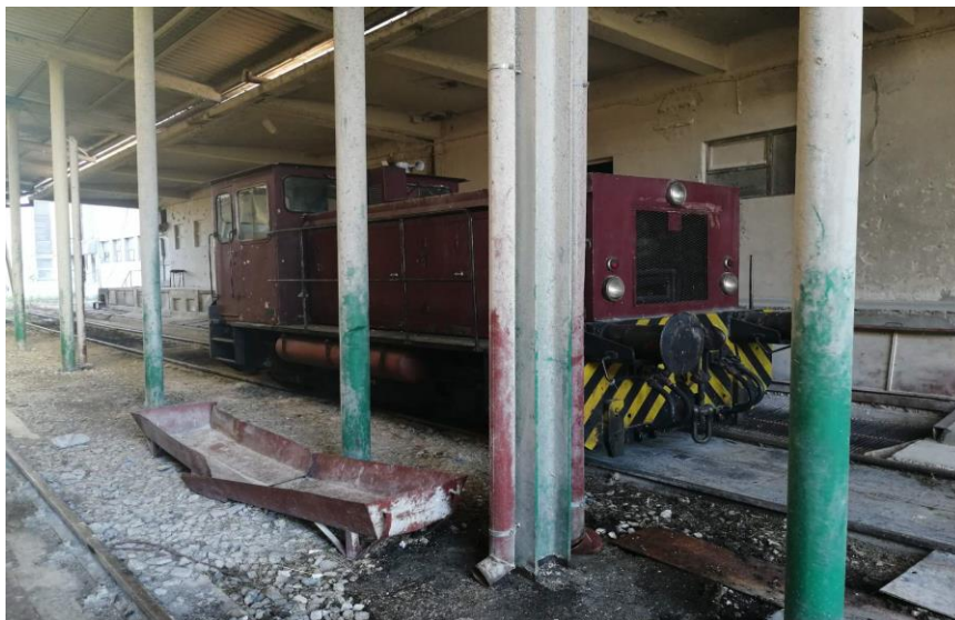
Slika 29 Manevarska lokomotiva za vuču vagona na industrijskom kolosijeku (Izvor: Autor)
