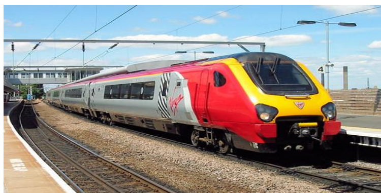
Slika 17 Biodizel vlak kompanije Virgin na biodizel[3]
