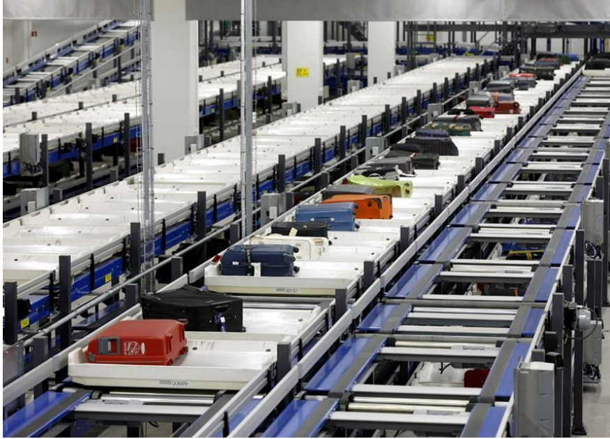
Slika 10. Sustav sortiranja prtljage na zračnoj luci Bergen u Flenslandu, Norveška.
