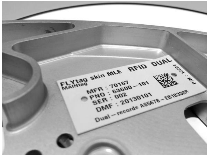
Slika 4. RFID oznaka u obliku naljepnice za dijelove zrakoplova.
