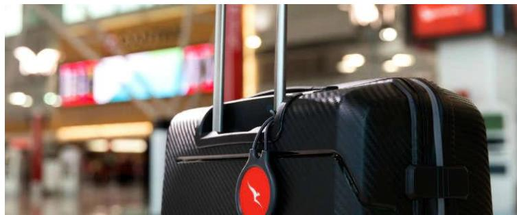
Slika 7. Trajni RFID prtljažni privjesak zračnog prijevoznika Qantas
