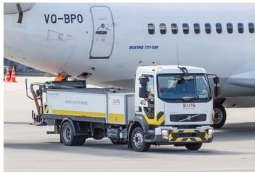
Slika 14. Vozilo za servis otpadnih voda [45]
