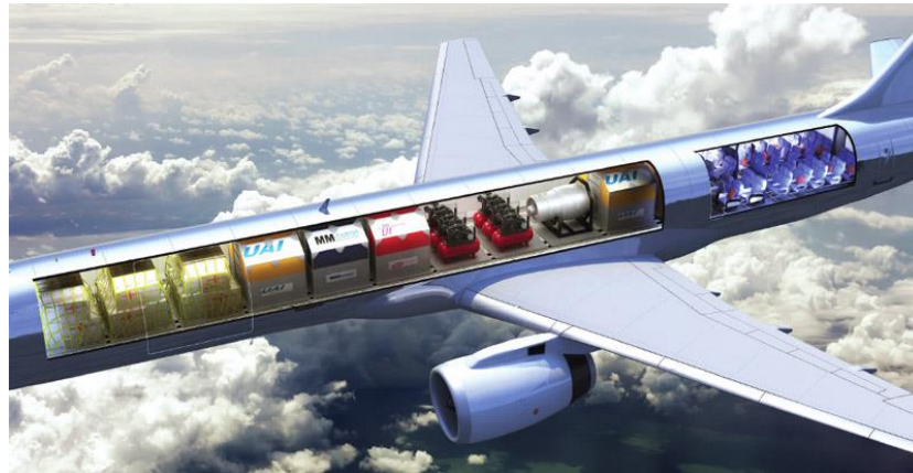
Slika 4. Konfiguracija kombiniranog zrakoplova, [10]
