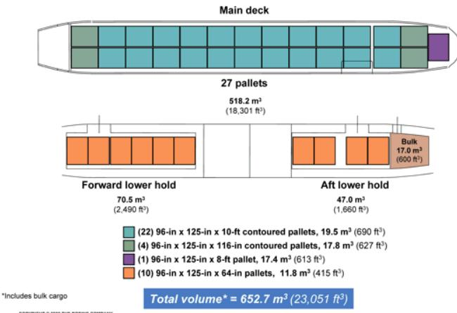
Slika 2. Tlocrt teretnog prostora Boeing-a 777F, [6]
