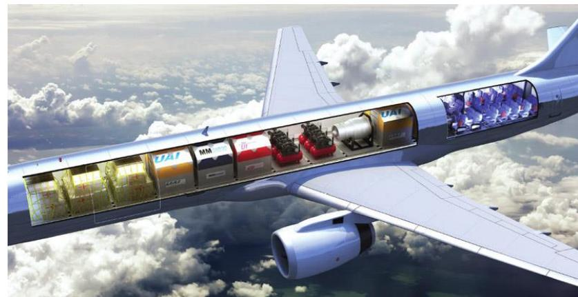
Slika 4. Konfiguracija kombiniranog zrakoplova, [10]
