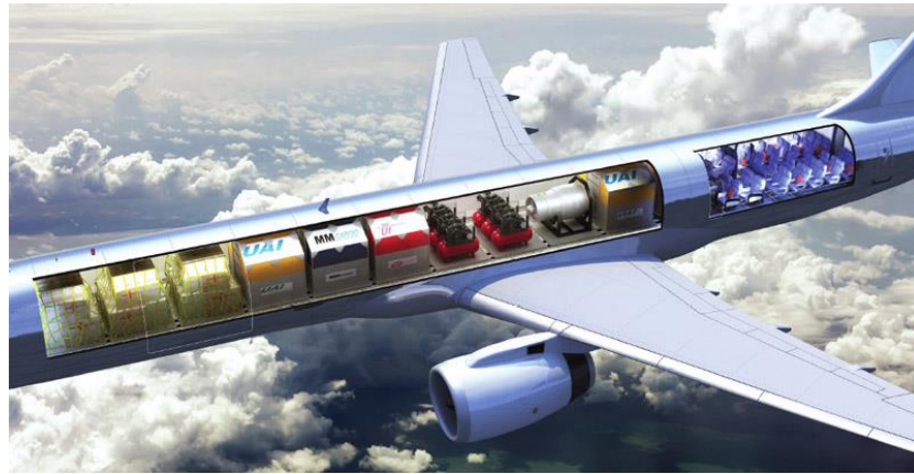
Slika 4. Konfiguracija kombiniranog zrakoplova, [10]
