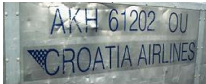
Slika 9. Primjer označavanja zrakoplovног kontejnera, [8]
