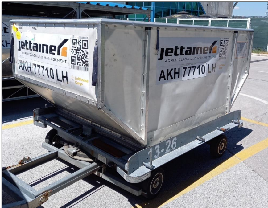
Slika 3: Prikaz ULD kontejnera tipa AKH
