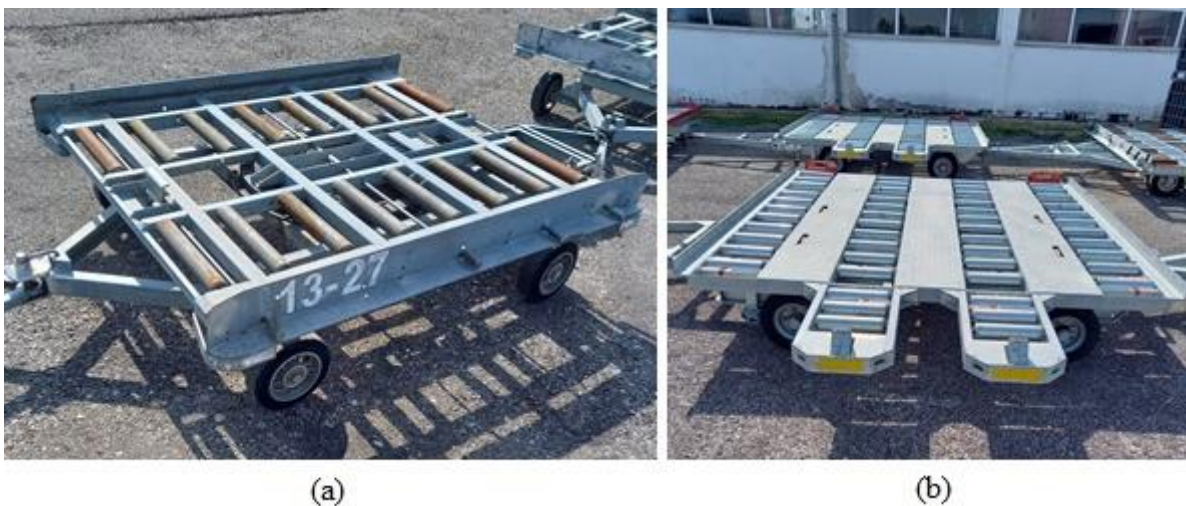
Slika 7: (a) Dolly kolica sa sustavom valjaka - kapaciteta jedan ULD; (b) Dolly kolica sa sustavom valjaka - kapaciteta dva ULD-a
