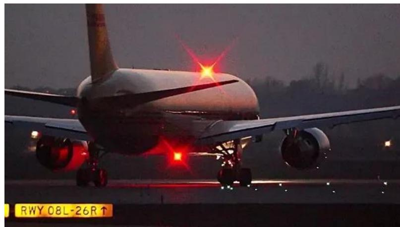
Slika 16. Protusudarna svjetla na zrakoplovu
