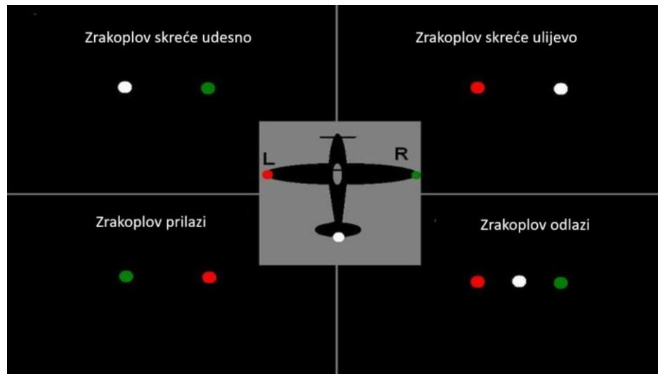
Slika 17. Navigacijska svjetla na zrakoplovu
