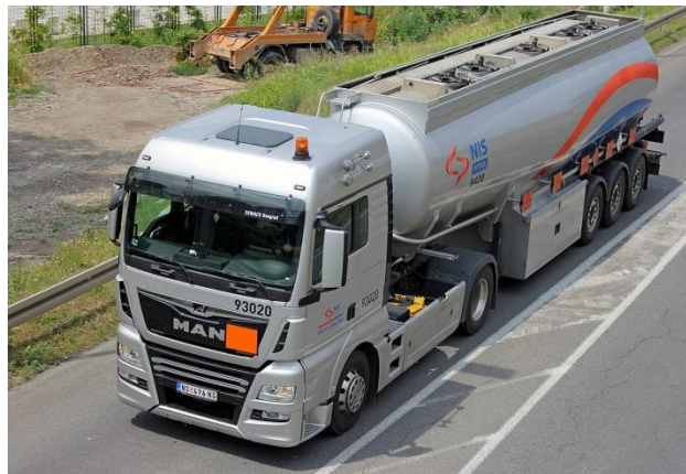
Slika 4 Dvoosovinski tegljač s tzv. cisternom
