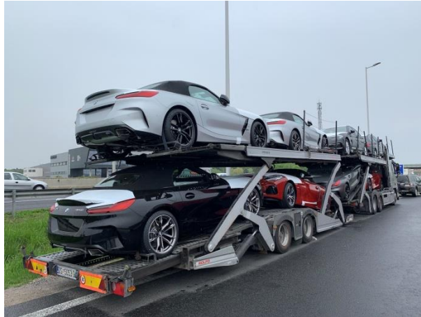
Slika 6 Poluprikolica za prijevoz automobila
