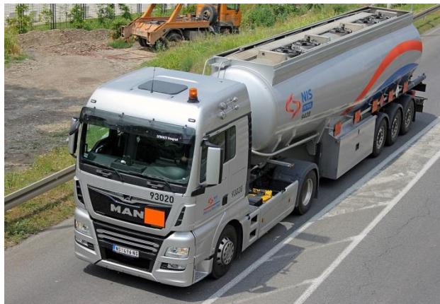
Slika 4 Dvoosovinski tegljač s tzv. cisternom
