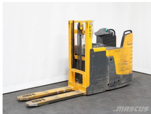
Slika 21. Električni viličar namijenjen skladišnim poslovima
