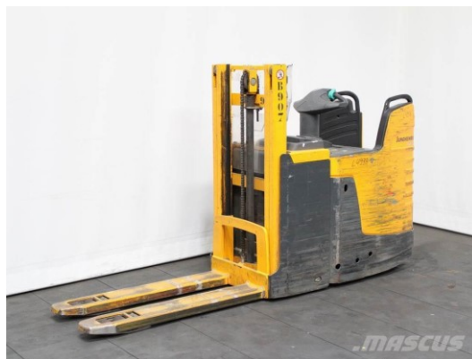
Slika 21. Električni viličar namijenjen skladišnim poslovima
