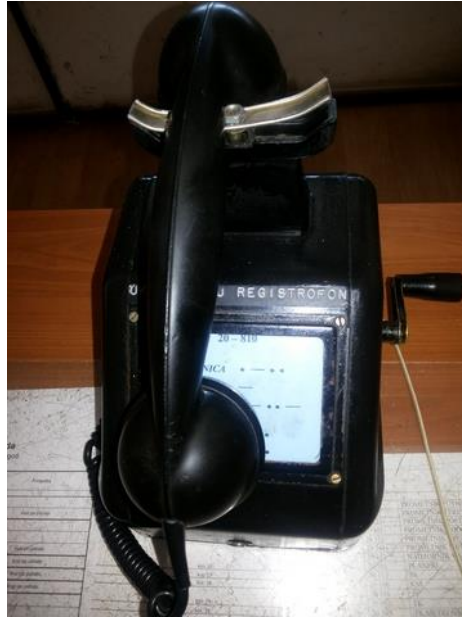
Slika 8. Induktorski telefon u kolodvoru Ploče
