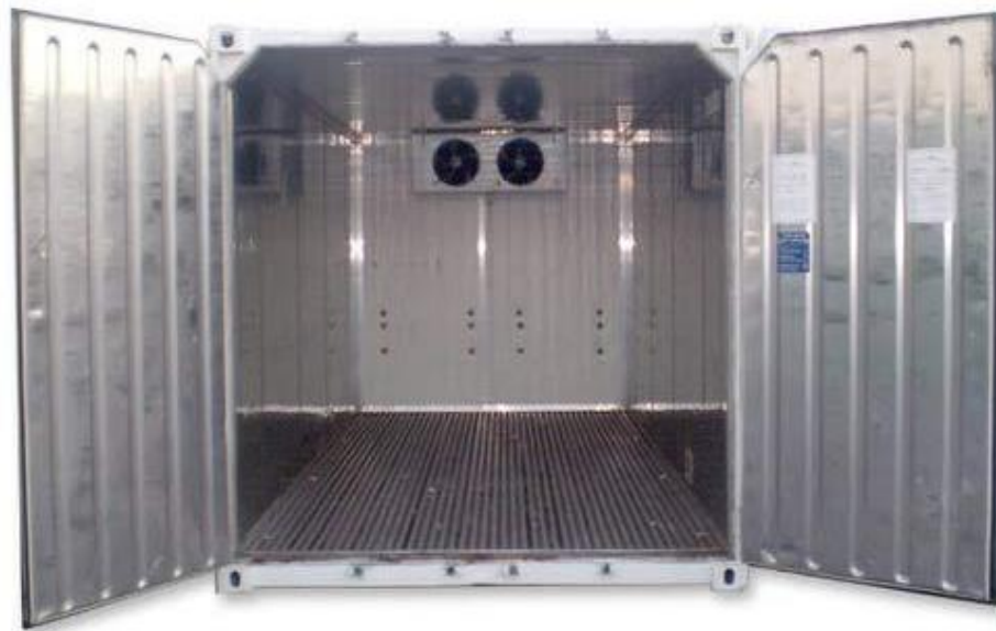
Slika 2. Prijevozna jedinica s rashladnim uređajem
