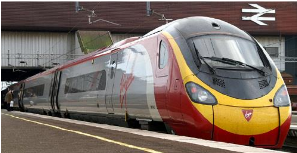
Slika 3.9. Pendolino 390, nagibni vlak, UK
