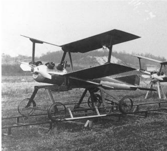
Slika 1. Prva bespilotna letjelica Ruston Proctor Aerial Target
