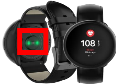
Slika 21. Prikaz pozicije senzora otkucaja srca na pametnom satu.
