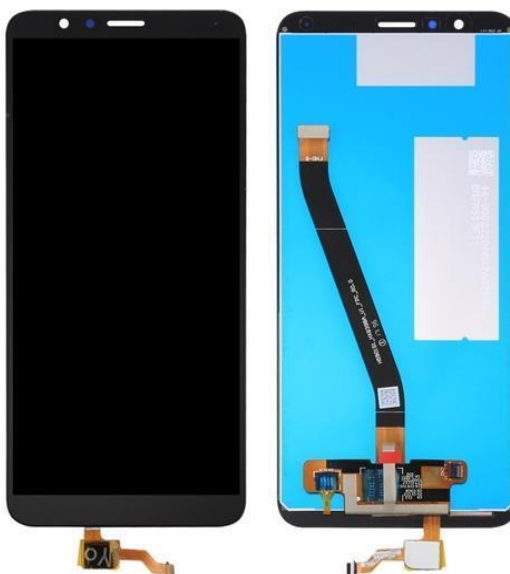
Slika 8. Modul zaslona osjetljivog na dodir, [12].
